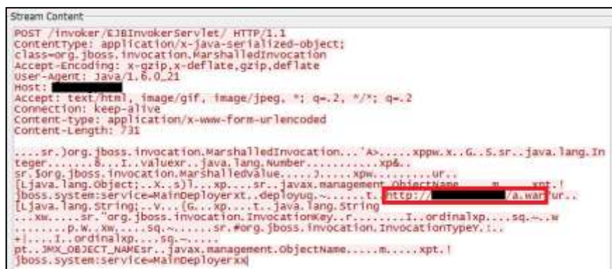
図 5 JBoss AS に対し不正なファイルをアップロードし、展開する試み
